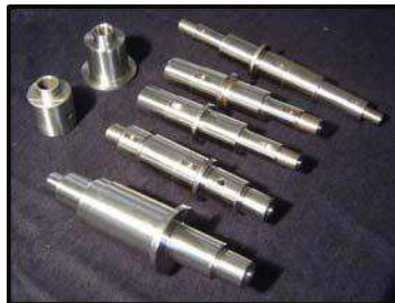
EJES DE BOMBAS
