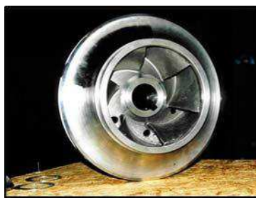
ROTORES DE BOMBAS
